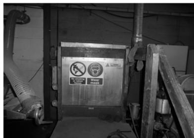
La foto n.2 mostra l'apertura del sistema per l'introduzione e l'estrazione dei componenti da pulire e, a destra, il condotto del sistema di aspirazione.
